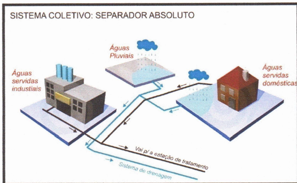
Figura 5: Sistema de esgotamento sanitário coletivo: separador absoluto
