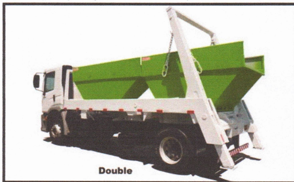
Figura15: Transporte tipo Poliguindaste Double com capacidade mínima de 7t ou até 10 m 3
